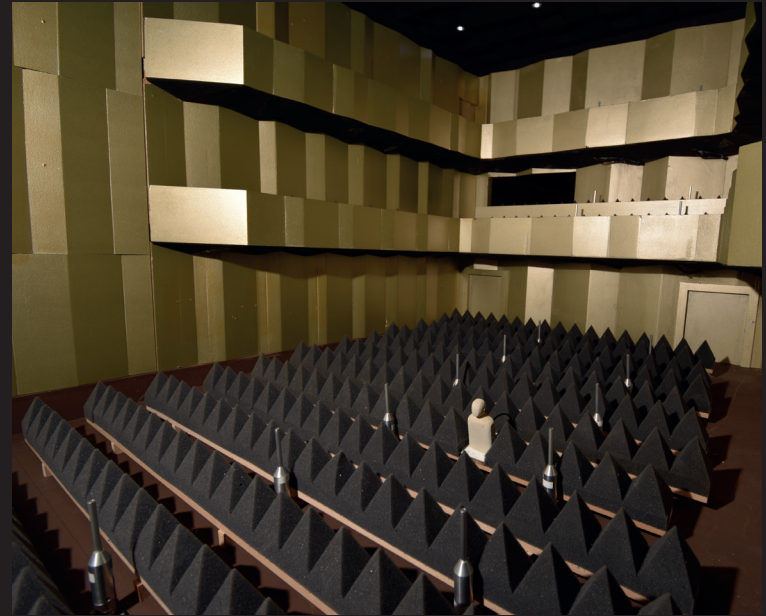
Akustisches Massstabmodell 1:10 zur Optimierung der Raumakustik
